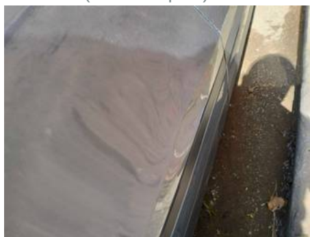
Porte arrière droite (Défaut aspect)
